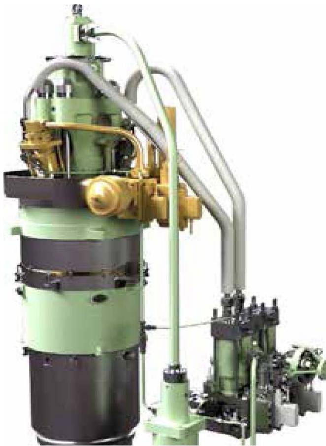
Рисунок 2.7 Кришка циліндрів, оснащена інжекторами паливних підсилювачів та блоком керування LGI (всі труби паливного блоку є двостінними)
