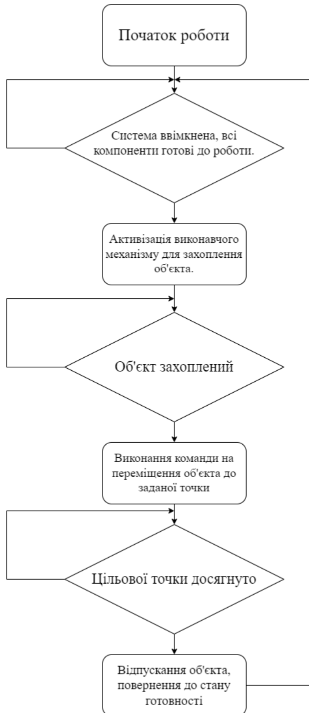
Рисунок 4.2 Блок схема алгоритм послідовності дій системи
