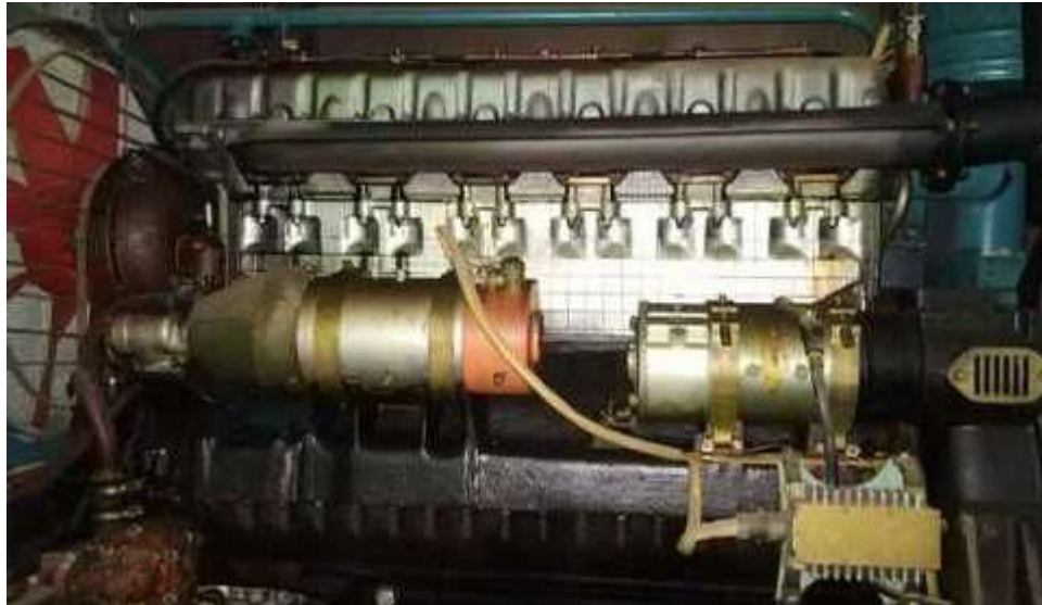
Рис. 1.1 – Двигун 6ЧН 15/18 (серія Д6) вид збоку.
