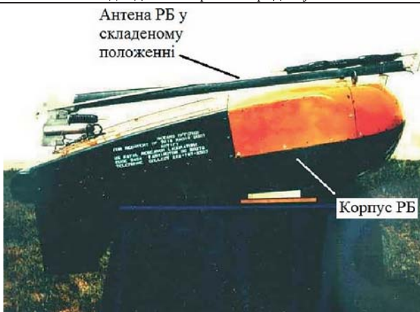
Рисунок 1.4 – Система зв'язку «AN/BSQ-5 Towed Buoy» для атомних підводних човнів SSN «Sturgeon», США (клас 637) [15]
