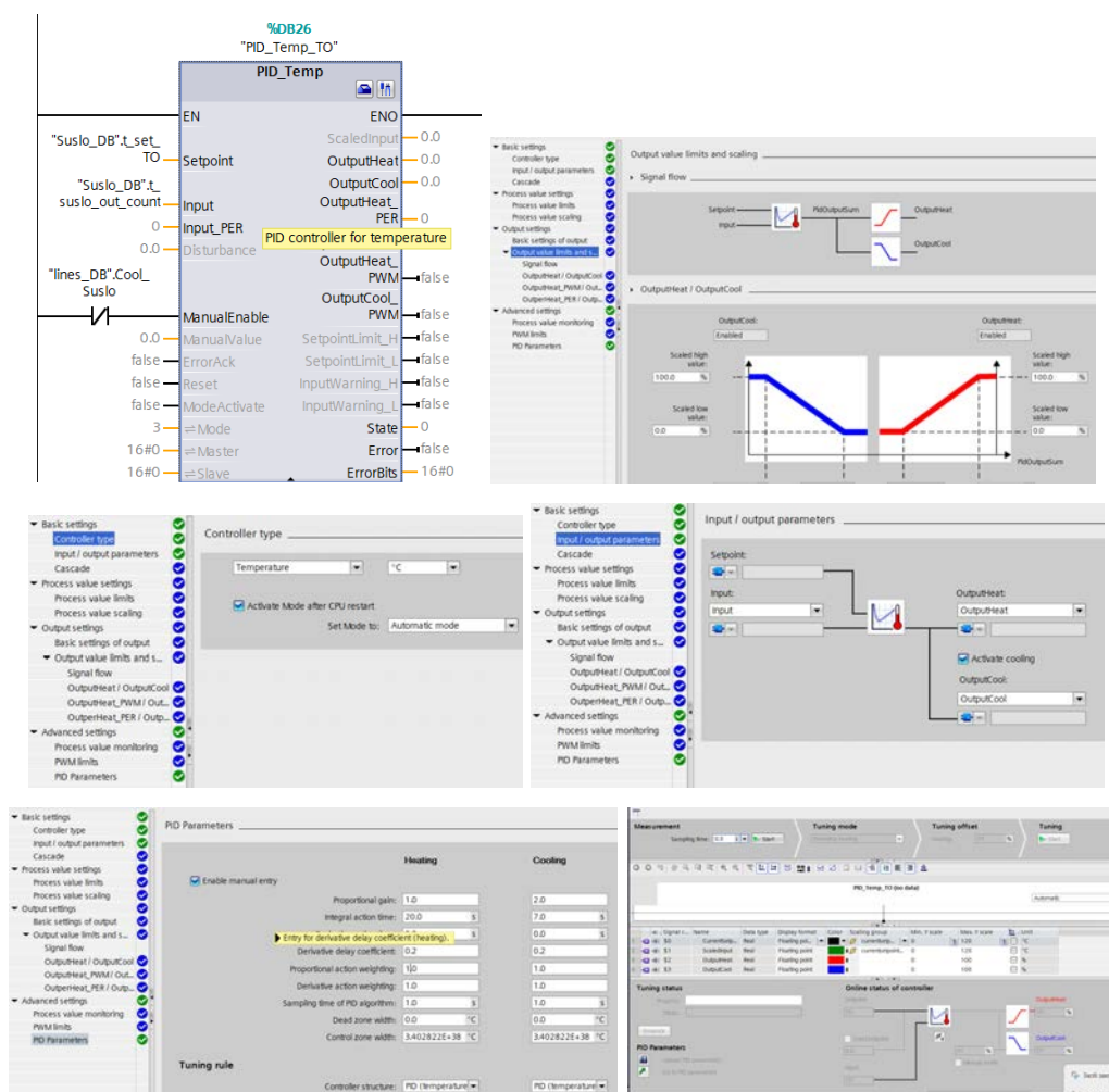
Рис. 2. Налаштування системи в середовищі Siemens TIA Portal на об'єкті дослідження
