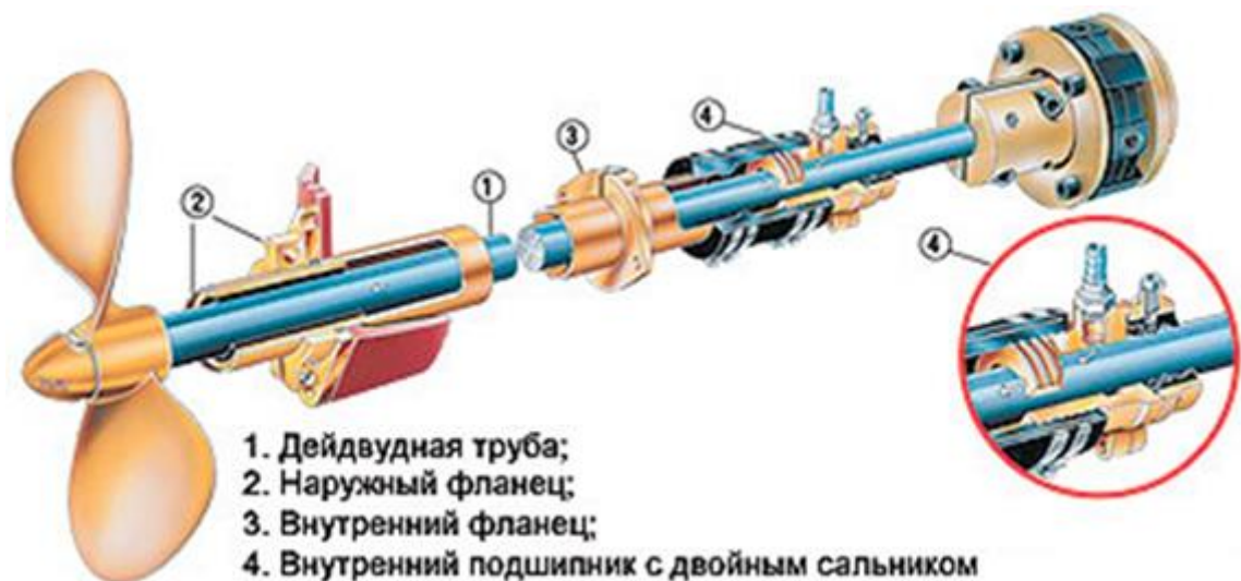
Рис. 2.7 – Конструкція кормової частини валопроводу
