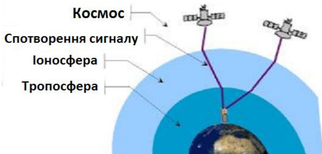
Рисунок 1.3 Схема спотворенню сигналу при проходженні крізь атмосферу.
