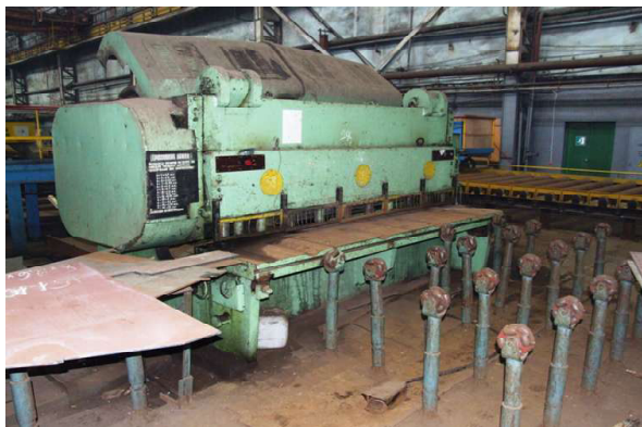
Рис. 3.19. Гильотинные ножницы для механической резки листового проката
