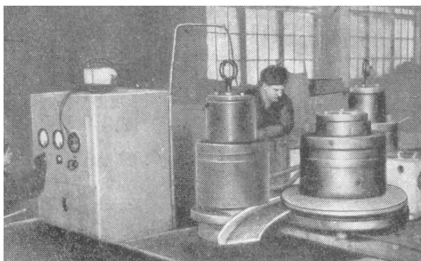
Рис. 3.41. Гибка профиля на станке с нагревом токами высокой частоты в корпусообработывающем цехе
