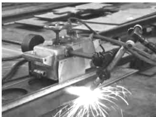
Рис. 3.17. Переносная машина для газовой резки
