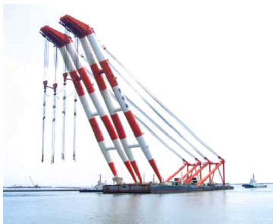
Рис. 5.26. Плавучий кран грузоподъемностью 3600 т
