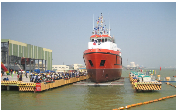
Рис. 6.12. Спуск судна с помощью вертикального судоподъемника на судостроительной верфи во Вьетнаме
