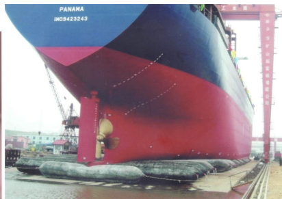
Рис. 6.34. Судно на баллонах готово к спуску на воду
