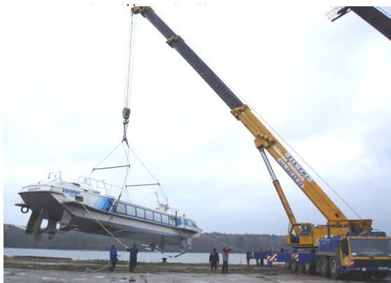
Рис. 6.13. Спуск судна на подводных крыльях автокраном на волжской судовой верфи (Россия)
