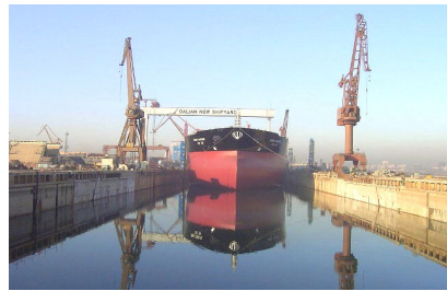
Рис. 6.3. Спуск судна в строительном доке Dalian New Shipbuilding Navi Industry Co., Ltd. (Китай)
