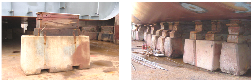
Рис.5.15. Унифицированный железобетонный кильблок (слева) и клетки (справа)
