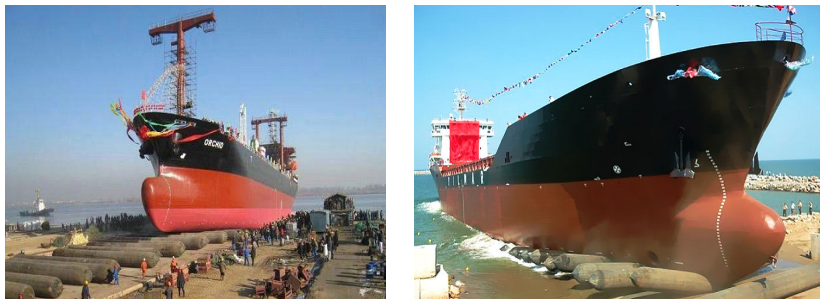
Рис. 6.25. Спуск судов на пневматических баллонах с наклонных продольных стапелей (Китай)
