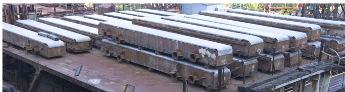
Рис. 6.24. Стальные спусковые полозья, подшитые листами из алюминиево-магниевого сплава (в перевернутом положении)
