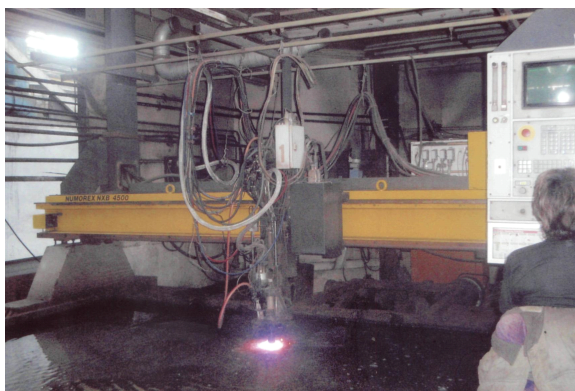
Рис. 3.16. Машина "Telereх TXB 10200" с числовым программным управлением для плазменной резки под водой
