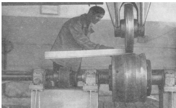
Рис. 3.45. Гибка профиля на станке ЛГС
