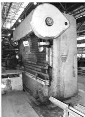
Рис. 3.34. Кромкогибочный пресс гильотинного типа
