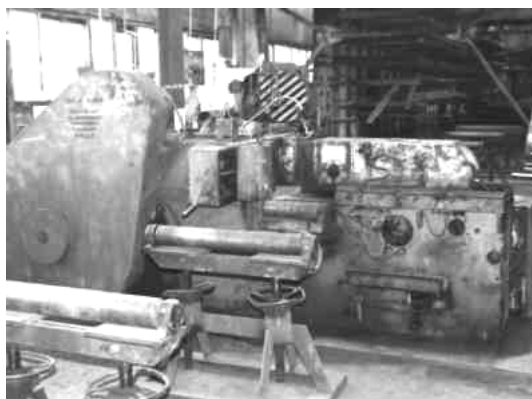
Рис. 3.43. Общий вид горизонтально-гибочного прессы типа "Бульдозер"
