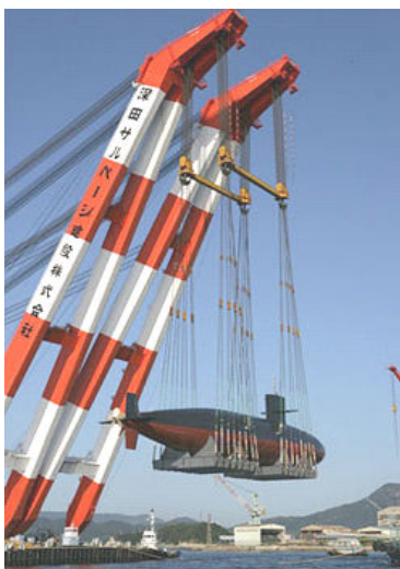
Рис. 6.14. Спуск подводной лодки плавучим краном на верфи в Китае
