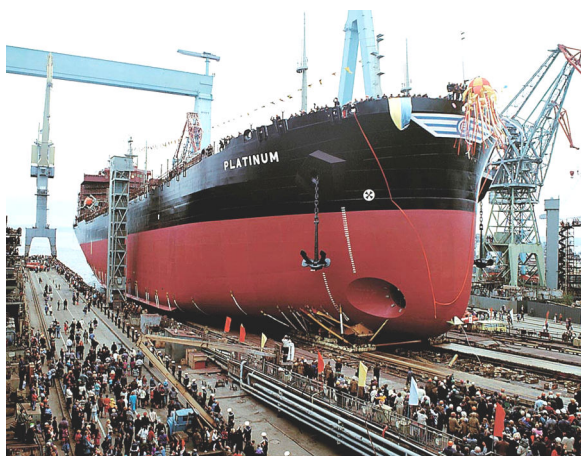
Рис. 6.23. Спуск танкера с наклонного продольного стапеля на Черноморском судостроительном заводе (г. Николаев)
