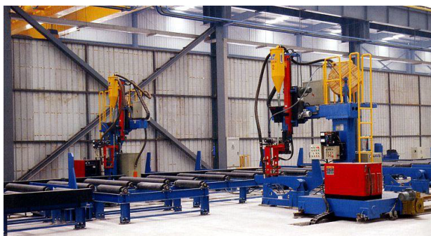
Рис. 4.16. Общий вид портальной автоматической установки для сварки под флюсом крупных балок
