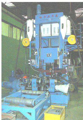
Рис. 4.14. Станок для сварки двутавровых балок
