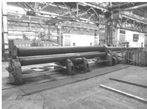
Рис. 3.27. Трехвалковые вальцы открытого типа с промежуточными опорами фирмы "Фрорип"
