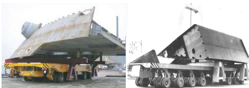
Рис. 5.22. Транспортёры с секциями корпуса судна
