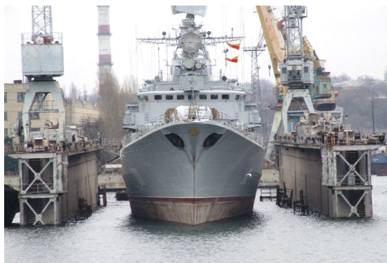
Рис. 6.9. Спуск судна с помощью плавучего дока
