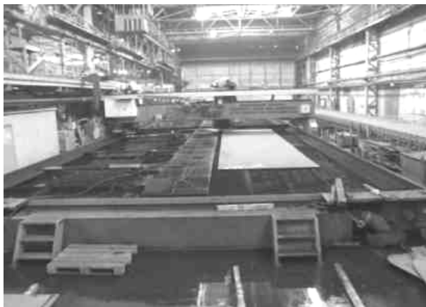
Рис. 3.14. Стационарная машина с числовым программным управлением для газовой резки
