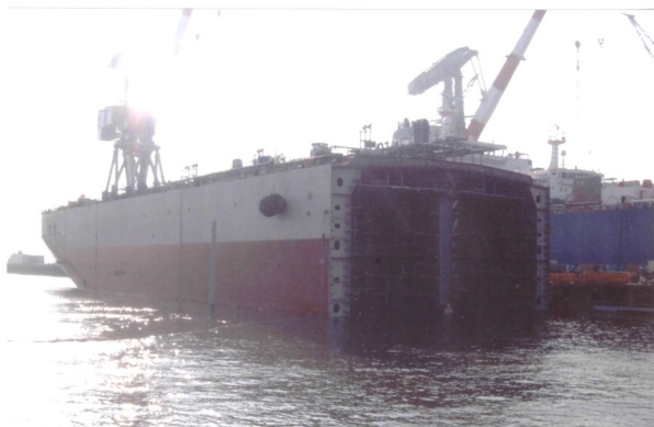
Рис. 5.34. Формирование корпуса судна из двух частей, отдельно спускаемых на воду
