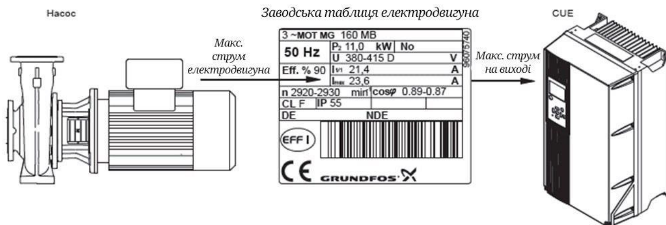
Рисунок 3. 19 – Підбір CUE на підставі максимального струму електродвигуна
