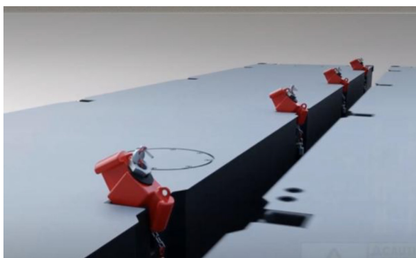
Рис. 2. Жорсткі зчеплення бетонних модулів
