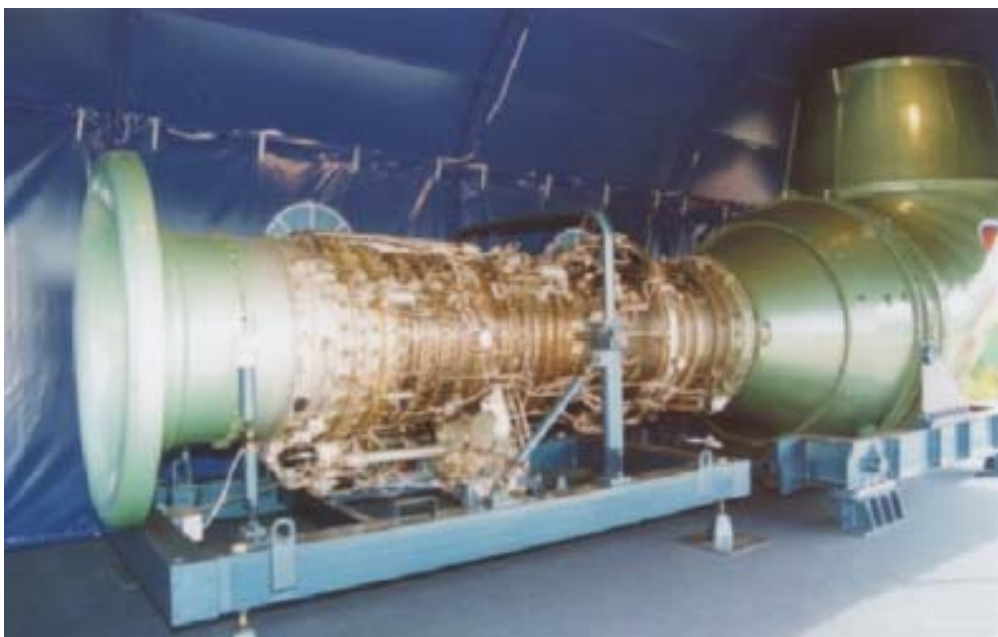
Рис. 21Д. Газотурбинный агрегат ГТЭ-20С
