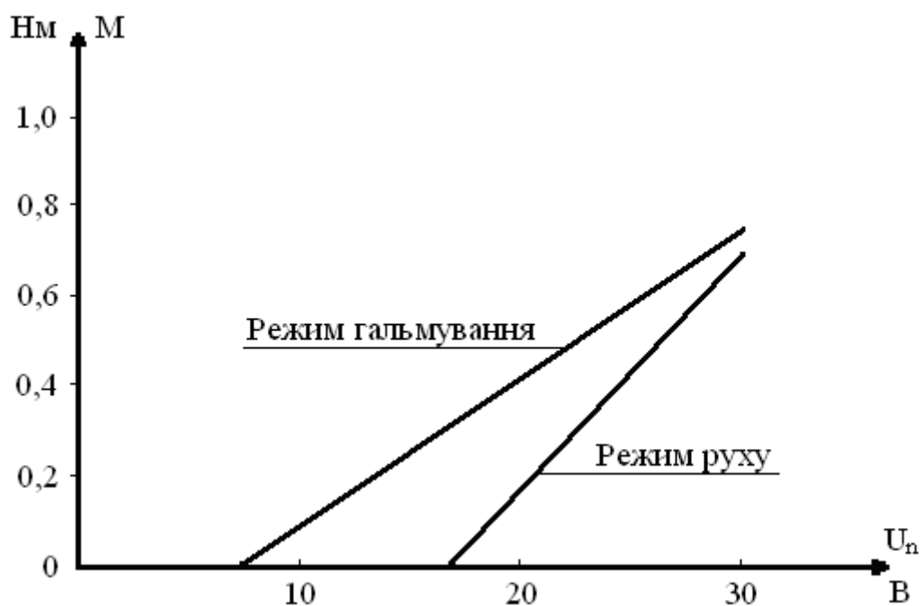
Рисунок 2.13– Статична та динамічна залежності п'єзоелектричного двигуна
