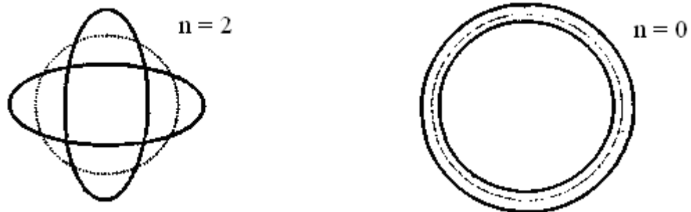
Рисунок 2.11–Форма коливань вигину Рисунок 2.12– Радіальний тип коливань
