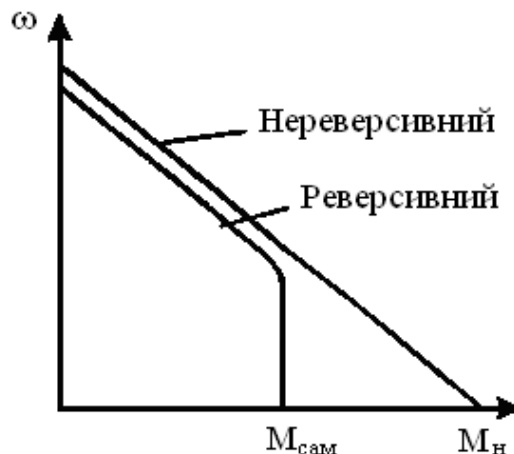
Рисунок 1.9—Типова навантажувальна характеристика п'єзодвигуна ( \omega – швидкість обертання, M_H – навантажувальний момент)
