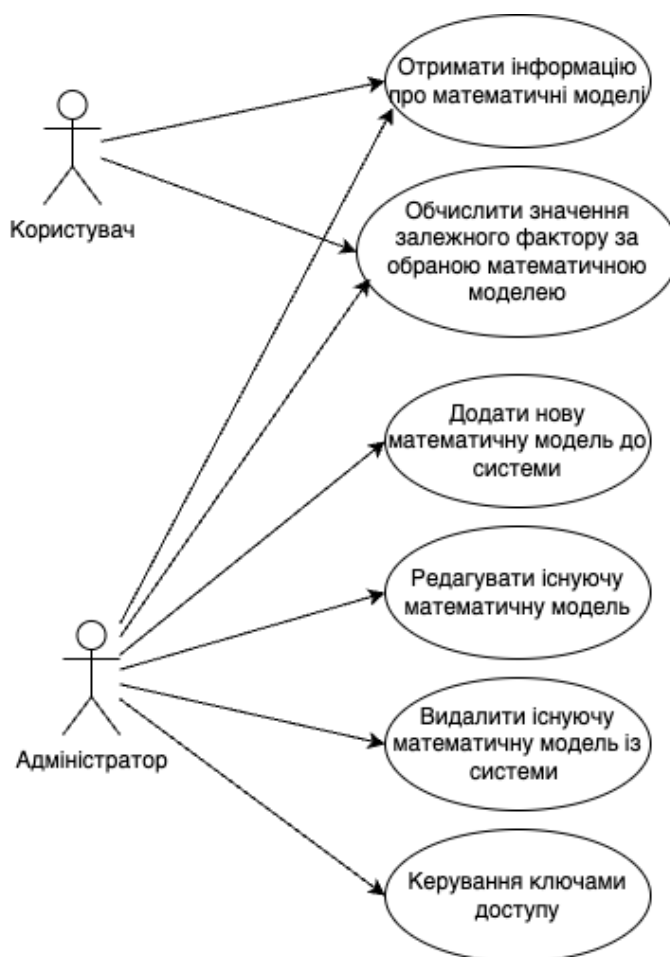
Рисунок 4.1 – Діаграма варіантів використання комп’ютерної програми «Сервіс для обробки інформації з метрик програмних застосунків»
