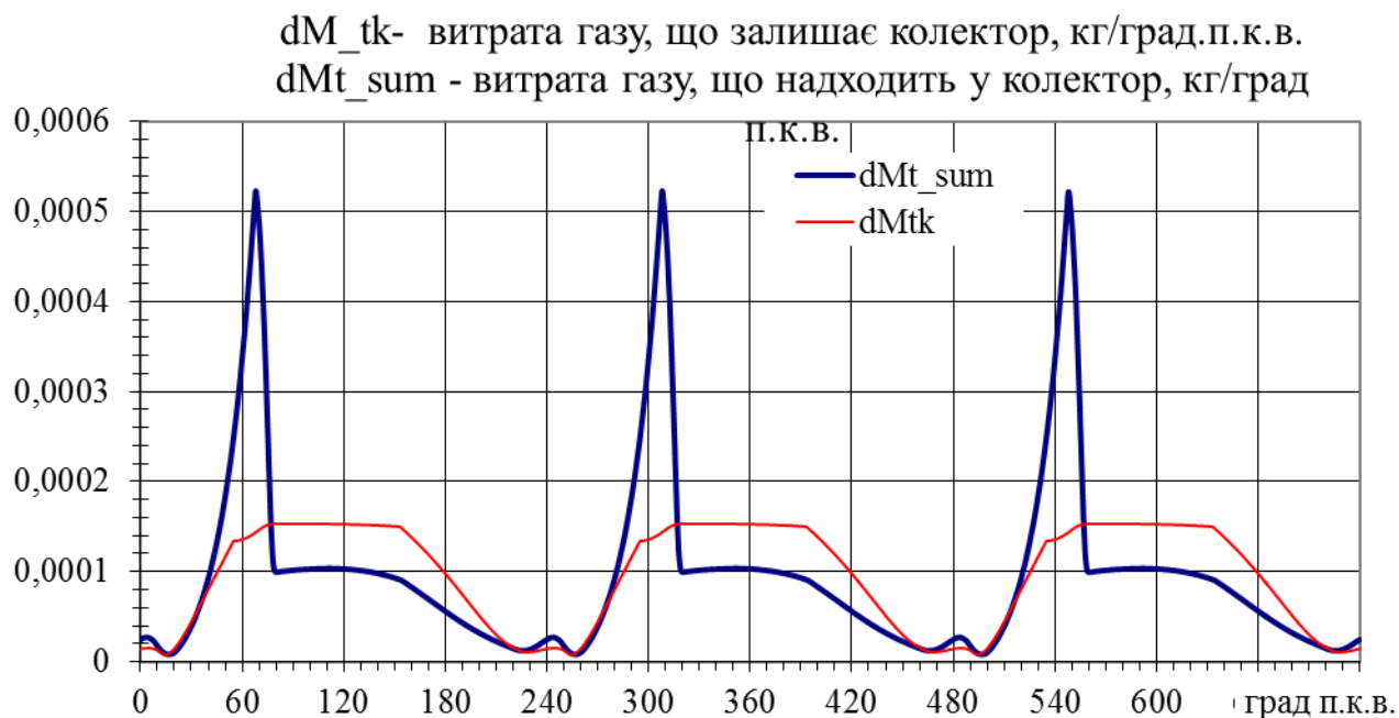
Рисунок 2.4 – Зміну маси газу у випускному колекторі суднового дизельного двигуна 6ЧН 21/21
