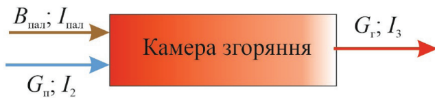
Рис. 3.4. До визначення теплового балансу камери згоряння
