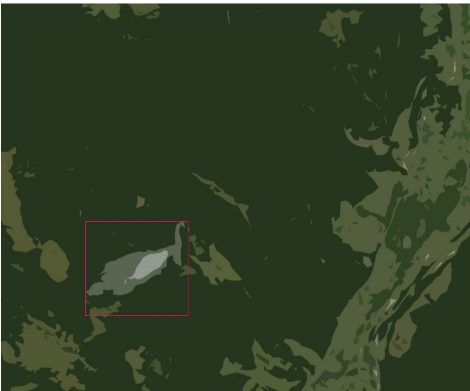
Рис. 2. Приклад сегментації зображення за допомогою методу kmeans() . Виявлення зовнішнього контуру лісової пожежі у Івано-Франківському лісгоспі України
