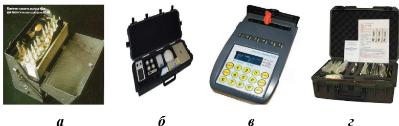
Рис. 19. Приборы биологического мониторинга: а – комплект средств для анализа проб КСАП-У; б – мобильный комплект биологического контроля МКБК; в – прибор Bio-Seeq PLUS; г – укладка иммунохроматографических индикаторных элементов «УИХЭ-1»
