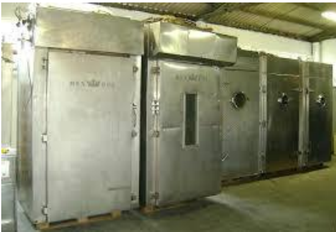
Рис. 1.3 - Рисунок печей копильно-варильного типу «REX-POL» із газовим та комбінованим підігрівом
