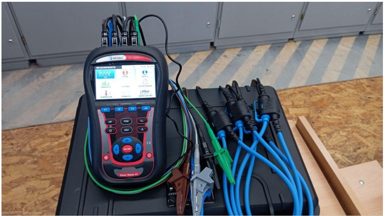
Рисунок 4.2 – Аналізатор якості електроенергії Metrel MI 2893 з комплектом вимірювальних датчиків
