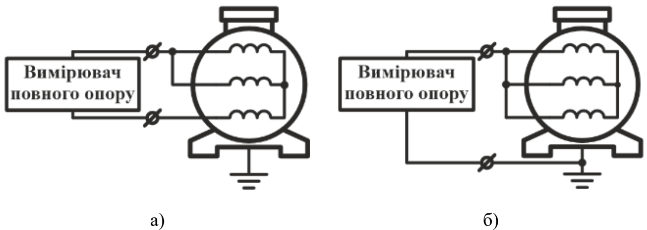
Рисунок 2.4 – Схеми для вимірювання повного опору обмоток статора АД
