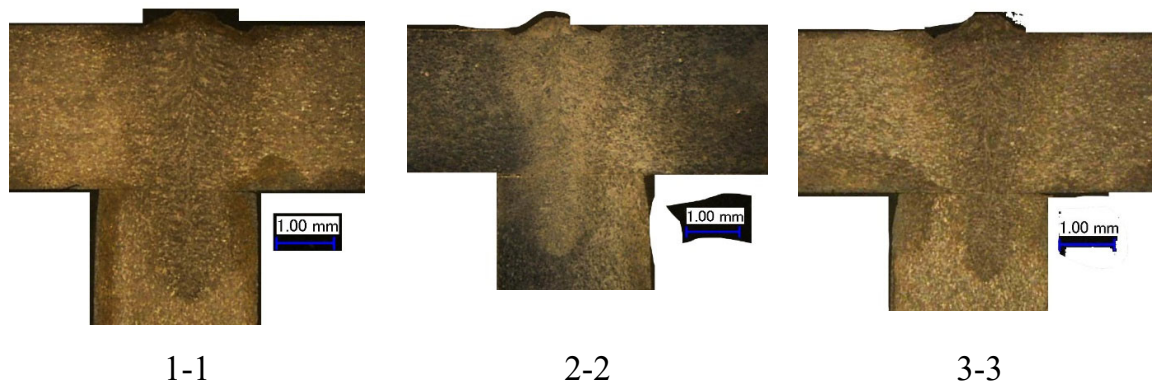
Рисунок 3.8 Макрошліфи з'єднання при P=4500 Вт
