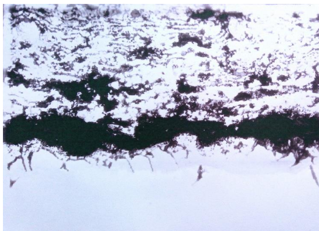
Рисунок 2.6 Мікроструктура термообробленого плазмового покриття чавун + 20 % міді на 18ХНВА [ \times 500 ]
