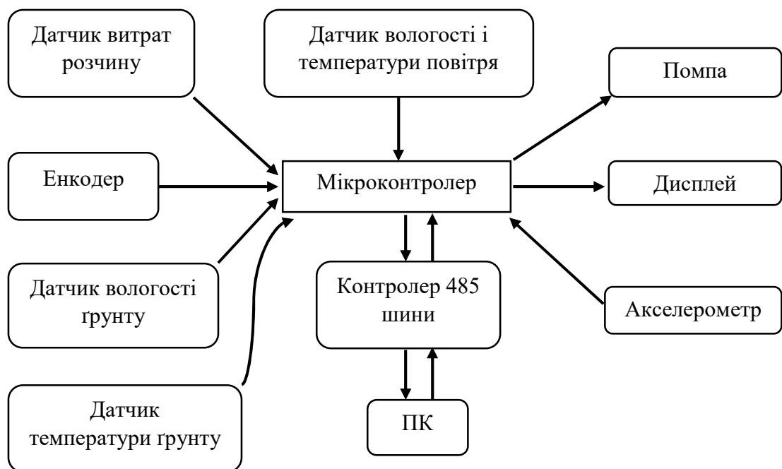
Рисунок 2.1 – Структурна схема системи моніторингу та керування вологістю ґрунту
