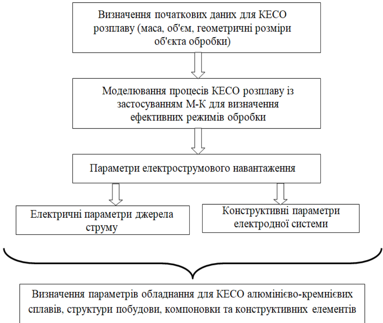
Рисунок 4.3 – Алгоритм вибору параметрів кондукційної електрострумової обробки алюмінієво-кремнієвих сплавів
