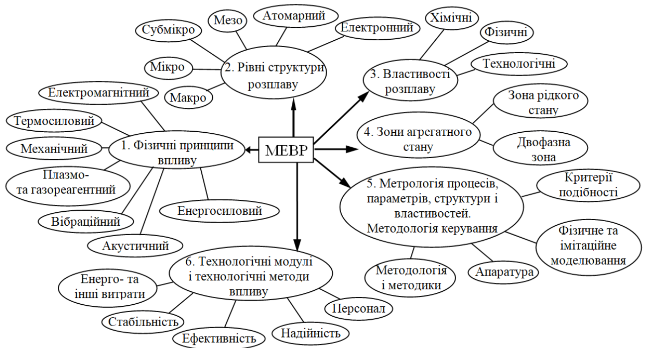
Рисунок 3.1 – Узагальнена система ознак для вибору методу енергетичного впливу на розплав: МЕВР – методи енергетичного впливу на розплав
