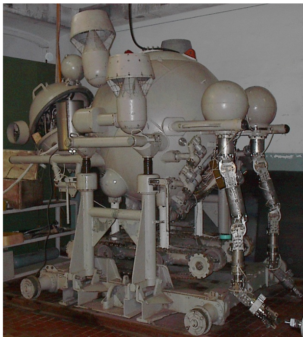
Рисунок 3 – Саморухомий (в погрузному і доному положеннях) опускний підводний апарат "МТК - 200"
