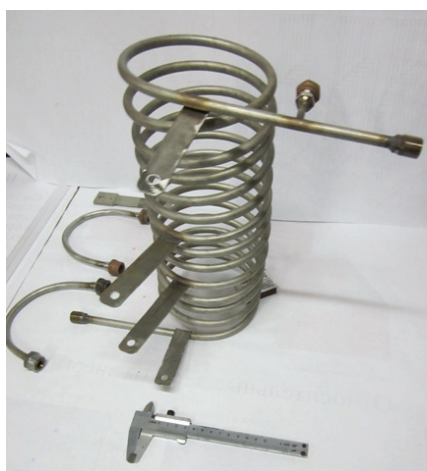
Рис. 3.2.3 – Термохімічний реактор для генерації синтез-газу з етанолу
