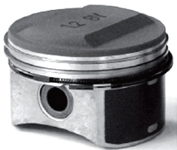
Рис. 1.2.2. Головка поршня з доопрацюванням у вигляді приливу для збільшення ступеня стиснення
