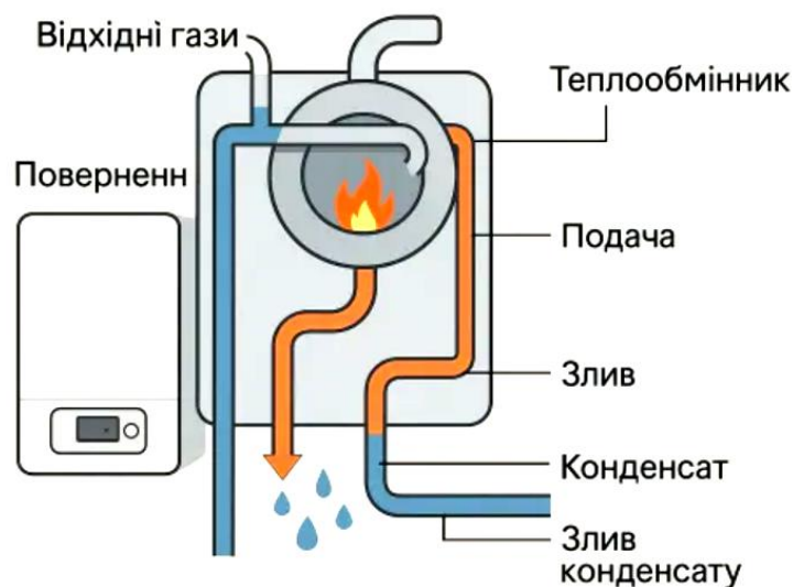
Рисунок 4.1. Принцип роботи 2-х контурного конденсаційного котла
