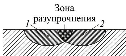
Рис. 3. Схема упрочнения плоской поверхности при поочередном прогреве отдельными полосами с перекрытием
