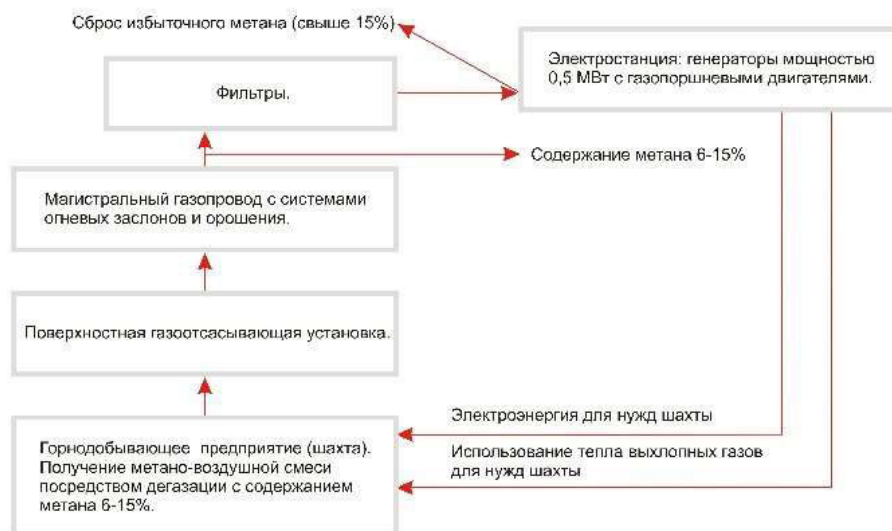
Рис. 3.3 - Принципова схема видобутку метану
