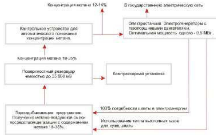
Рис. 3.2 - Принципова схема видобутку метану
