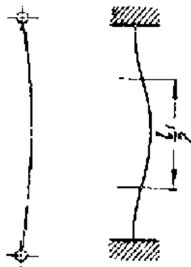
Рисунок 3.6 – Схема розрахунку стрижня шатуна двигуна 6ДКРН 80/230
