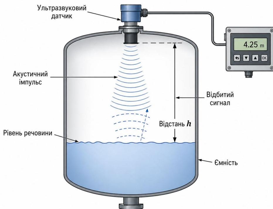
Рис. 1.9 — Схема вимірювання рівня речовини ультразвуковим датчиком
