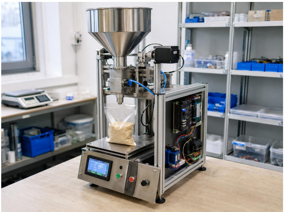
Рис. 1.6 — Приклад реалізації компактного автоматизованого дозатора з мікроконтролерним керуванням
