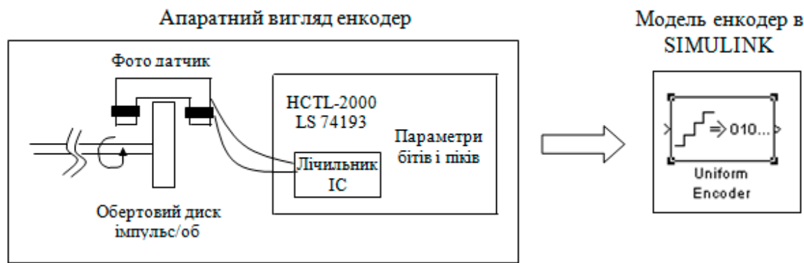
Рисунок 7 Апаратний і програмний вигляд енкодера
