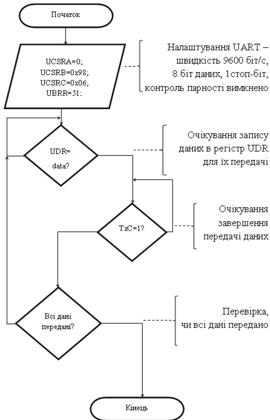
Рисунок 3.9 – Блок-схема алгоритму передачі даних в радіомодуль
