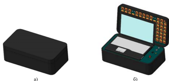
Рис. 5. Вигляд 3D моделі ПЕК БПА проекту «Глайдер» а) – транспортне положення; б) – робоче положення
