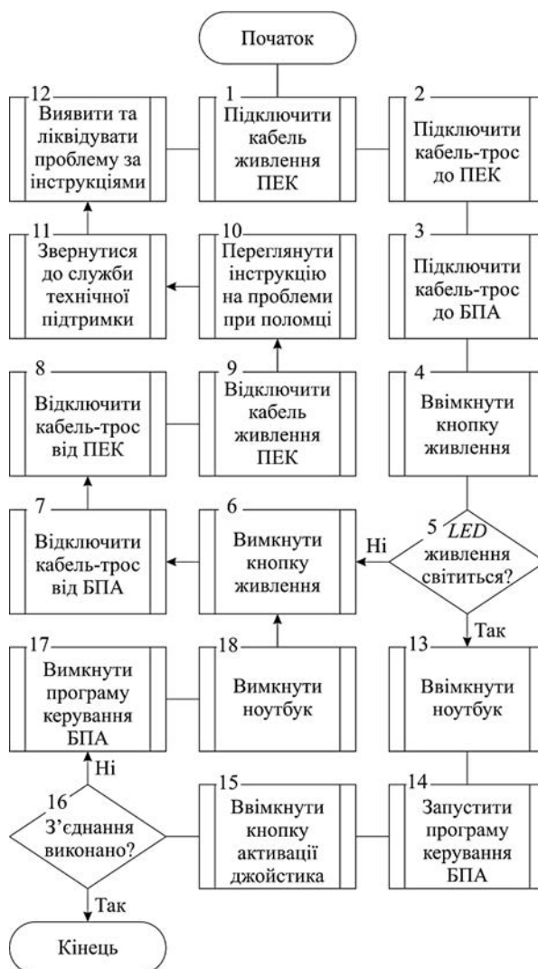
Рис. 3. Блок-схема алгоритму роботи з ПЕК БПА проекту «Глайдер»
