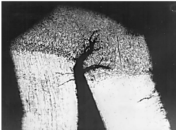
Рисунок 2.12 - Макроструктура зварного з'єднання, х 10
