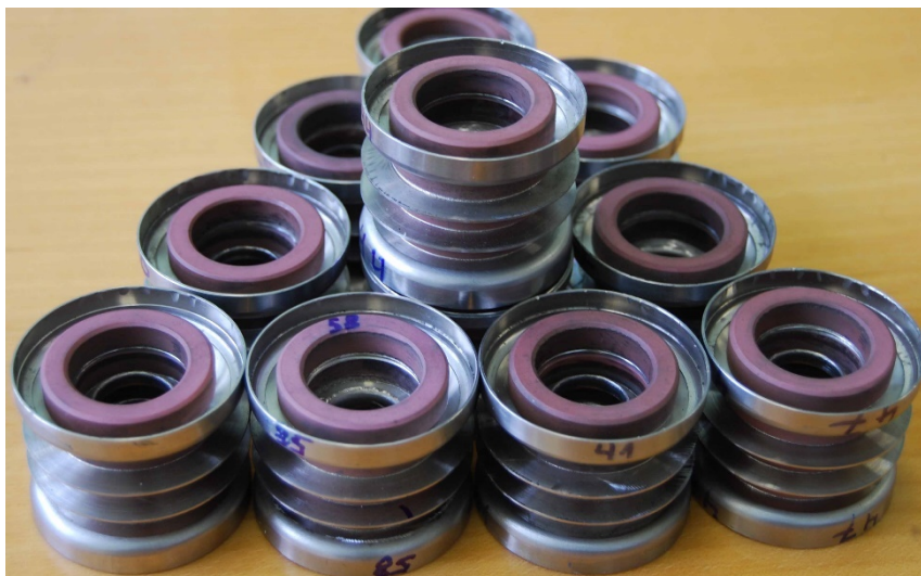
Рис. 4.6. Розріз по перерізу ( а ) та зовнішній вигляд ( б ) спаяних металокерамічних гермовводів, розрахованих на прискорюючу напругу 20 кВ, потужністю електронної гармати 60 кВт, для електронно-променевих установок: 1...5 кераміка марки ВК 94-1; 6...9 металеві електроди з прецизійного сплаву 29НК
