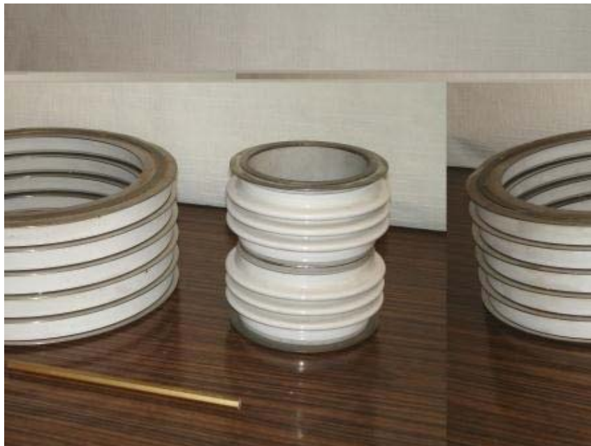
Рис. 1.7. Гермовводи серії ІАКВ, розраховані на напругу 60 кВ (зовнішній діаметр до 256 мм; секція прискорювальної трубки)
