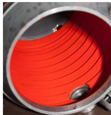
Рис. 3. Початковий колір ТФ, нанесеної на внутрішню поверхню ЖТ
