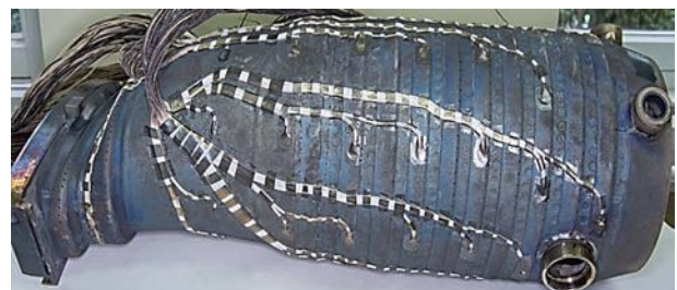
Рис. 2. Загальний вигляд жарової труби, препарованої термопарами
