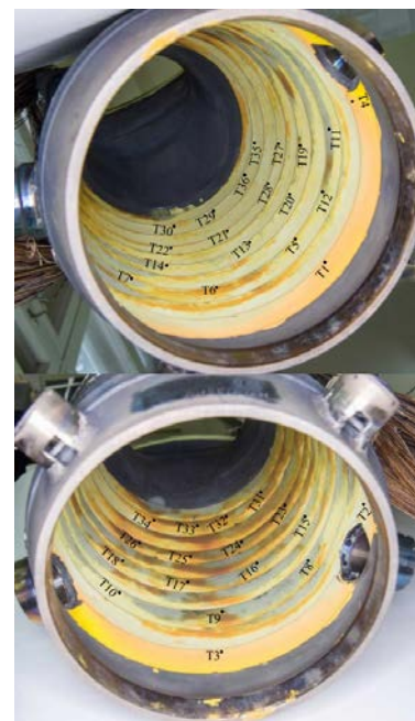
Рис. 5. Внутрішня поверхня ЖТ з розташуванням точок препарування ТП
