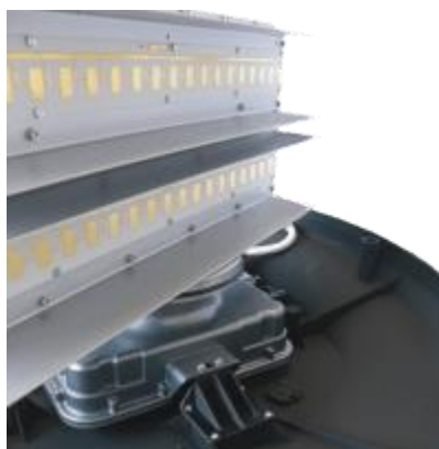
Рис.11 – мікрополоскова антенна решітка морського навігаційного FMCW-радіолокатора X-діапазону
