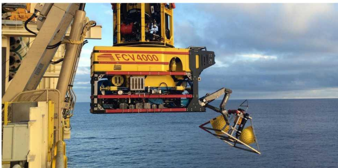
Рисунок 1.1 – Телекерований безлюдний підводний апарат із встановленою буровою системою.
