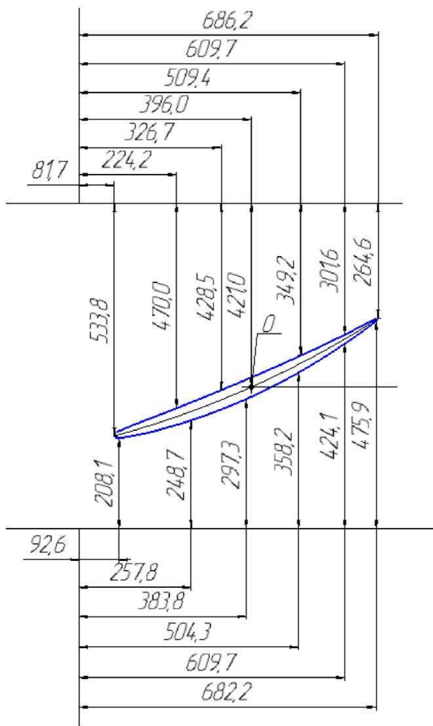
Рисунок 2.12 – Завдання координат поверхні профілю лопаті РК R=440 мм
