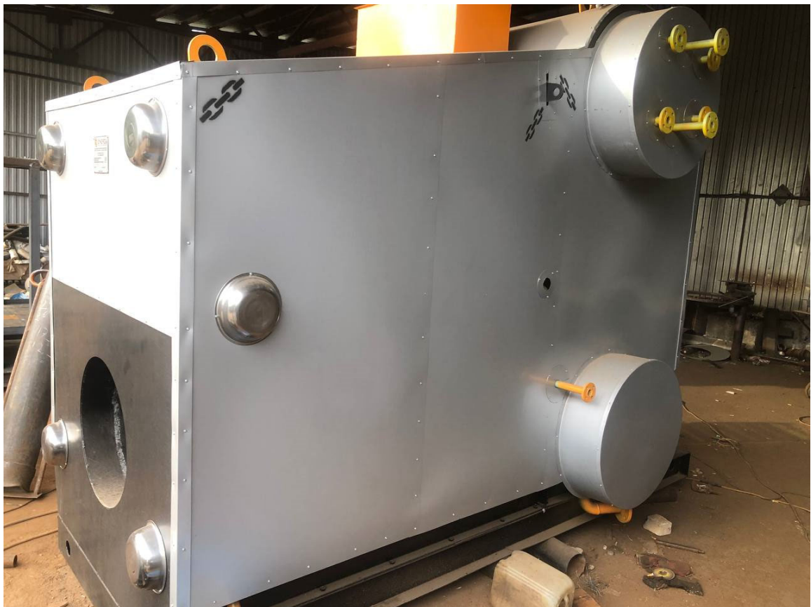
Рис. 5.3. Зовнішній вигляд котла Е–1/9-1
