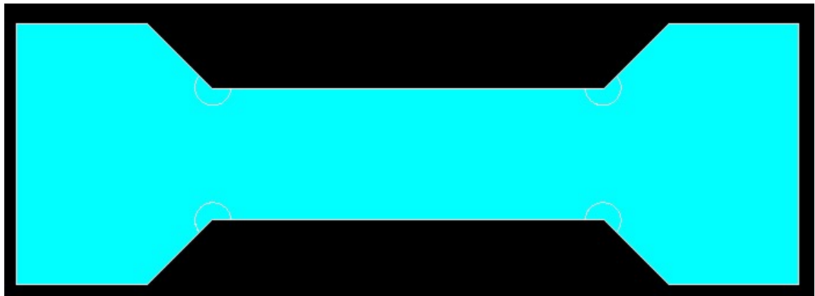
Рис. 3.8. Геометрична модель конструктивного вузла «злам кромки» при куті зламу 45 град та радіусі 0,5 мм
