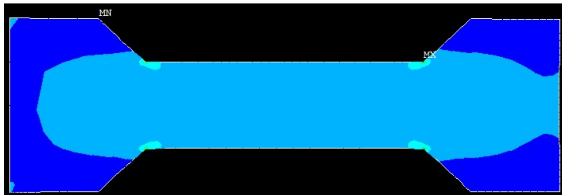
Рис. 3.11. Поле напружень при куті зламу 45 град та радіусі закруглення концентратора 0,5 мм ( K_t = 10,28 )
