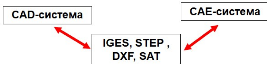
Рис. 2.6. Обмін даними між CAD- та CAE-системами через нейтральні формати файлів
