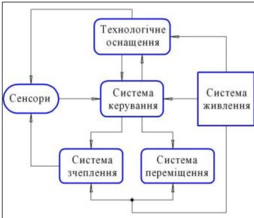
Рис. 1.1 – Загальна структура підсистем мобільних роботів
