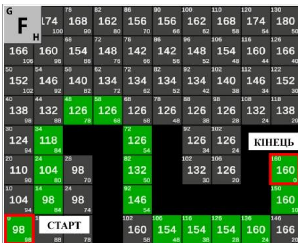
Рис. 1.3 – Робота алгоритму А-стар з позначеннями обрахованих F, G та H.
