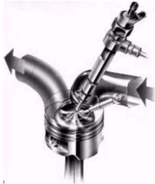
Рисунок 2.1 – Вертикальне розташування форсунок в голівці з чотирма клапанами і одним розподільним валом в дизелі Opel Ecotec (а) і похиле в голівці з двома клапанами в дизелі JTD Alfa Romeo 156 (б).
