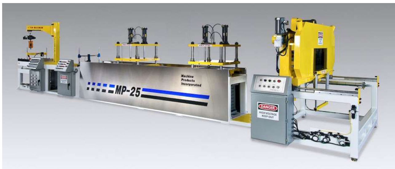
Рисунок 4.6 - Пултрузійна машина МРІ 25
