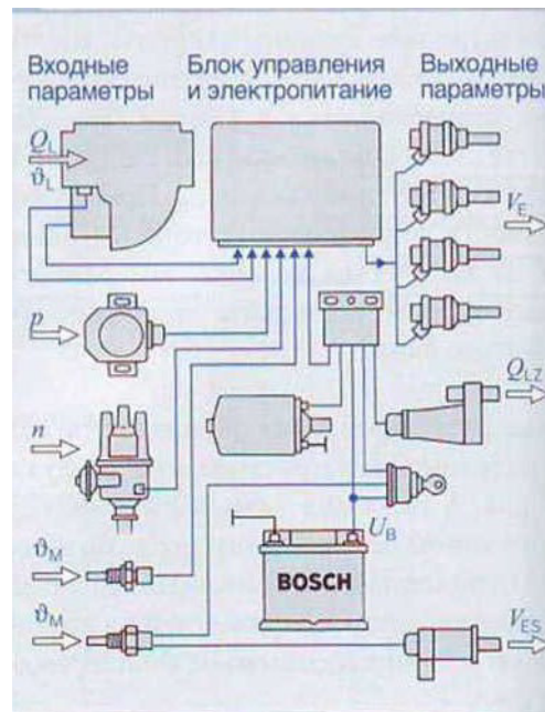
Рисунок 3.5 – Сигнали та регульовані параметри, які надходять та опрацьовуються у блоці керування
