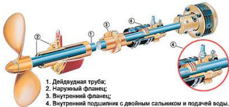
Рис. 2.5 - Схема кормової частини валопроводу
