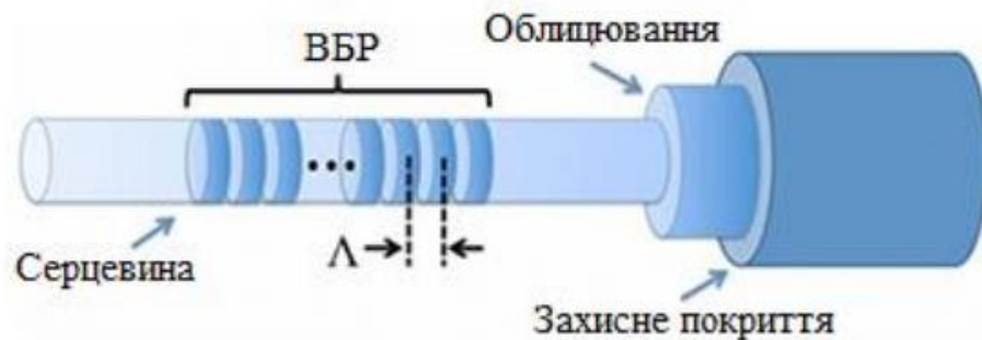
Рис.5.5 Детальний вигляд ВБР
