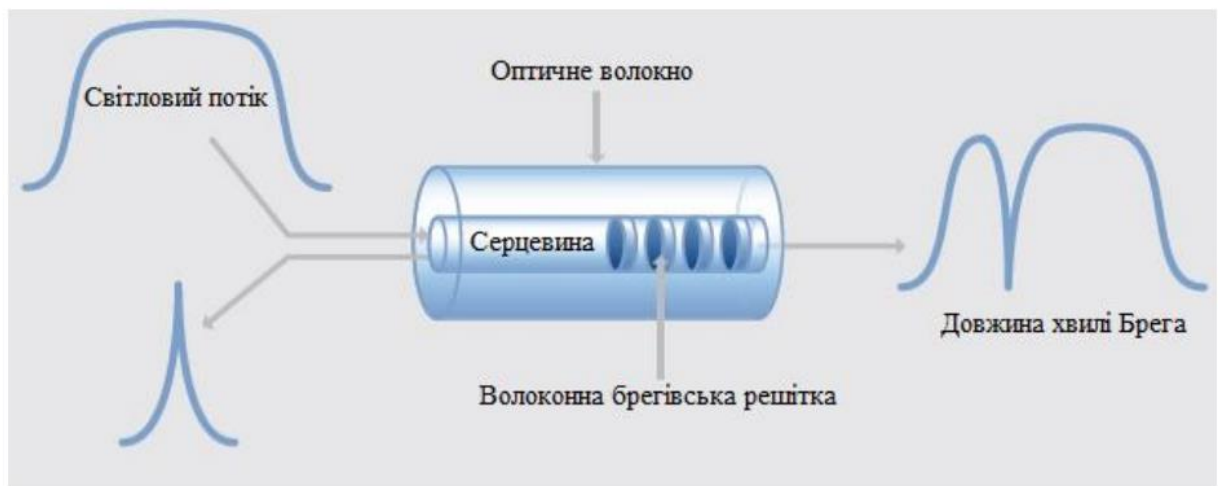
Рис.5.4 Робота оптичного датчика на ВБР
