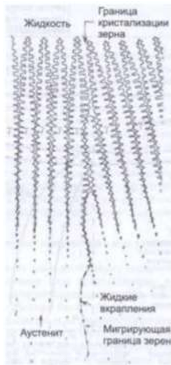
Рисунок 1.6 – Аустенітний механізм кристалізації [47]
