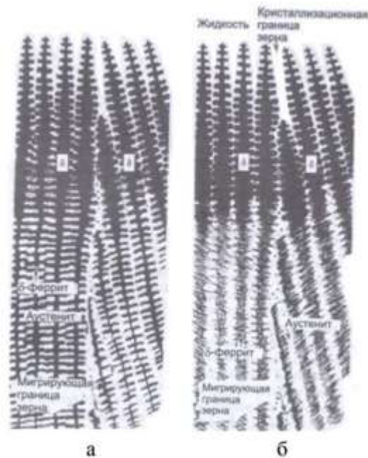
Рисунок 1.10 – Ферито-аустенітний механізм кристалізації: a – скелетна морфологія фериту, б – пластинчаста морфологія [45]
