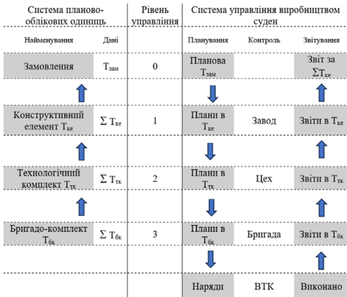
Рис. 1. Модель системи управління суднобудівним виробництвом
