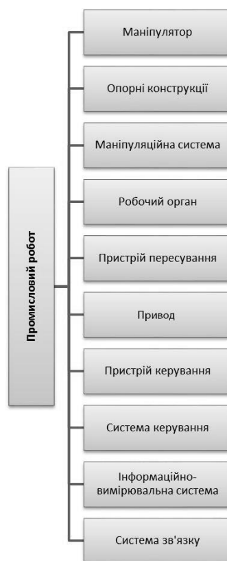
Рис. 1.1. Структурна схема промислового робота
