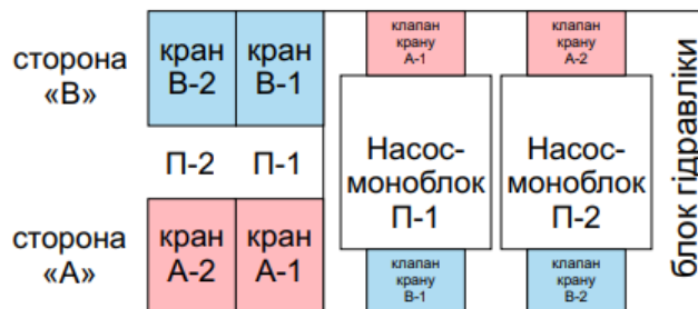
Рисунок 2 – Схема розташування насосів
