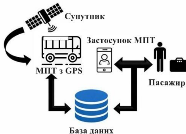
Рисунок 1.3 – Архітектура трекінгової системи обліку пасажирів за допомогою IoT-пристрою у транспортному засобі [сформовано автором на основі [10]]
