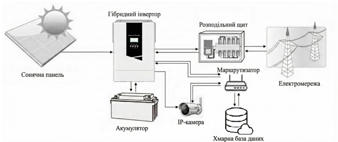
Рисунок 2.4 – Функціональна схема гібридного живлення ІР-камери
